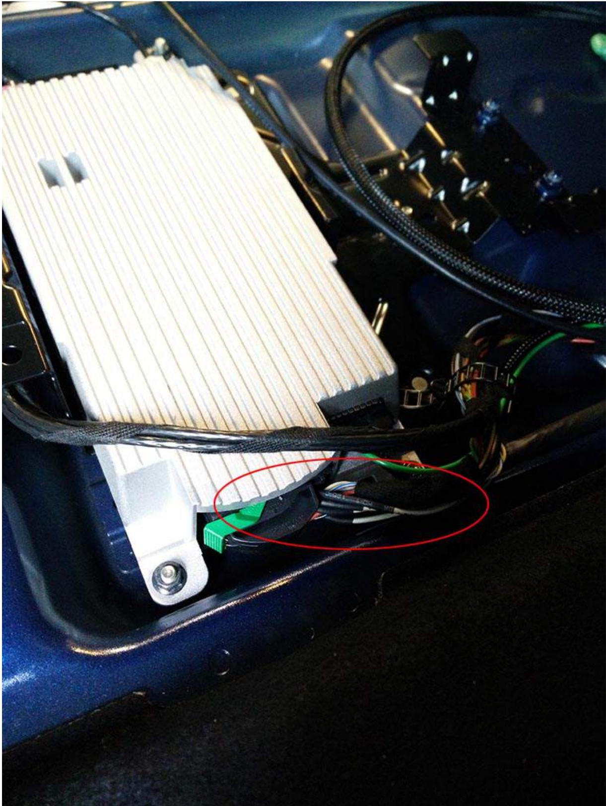
Das USB Kabel kann an den schwarzen oder blauen Anschluss angeschlossen werden, beides funktioniert, der Linke ist aber zu empfehlen, da er mehr Power liefert. Man muss wahrscheinlich am USB Stecker noch eine kleine Nase entfernen, da er sonst nicht in die Combox passt, einfach mal Stecker und Buchse begutachten, sieht man schon!
