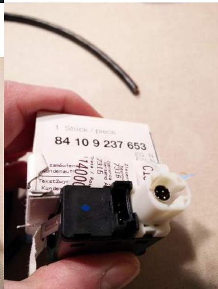
Daheim hatte ich eine Seite des Aux Kabel schon fertig gemacht, hier können die Adern aber ein Stück länger abisoliert werden! Sonst könnte es zu knapp werden, da die Pins sonst nicht ganz in den Stecker eingeschoben werden können und dadurch nicht einrasten. Am besten noch jede Ader mit Schrumpfschlauch überziehen und nach dem Einpinnen schrumpfen.
